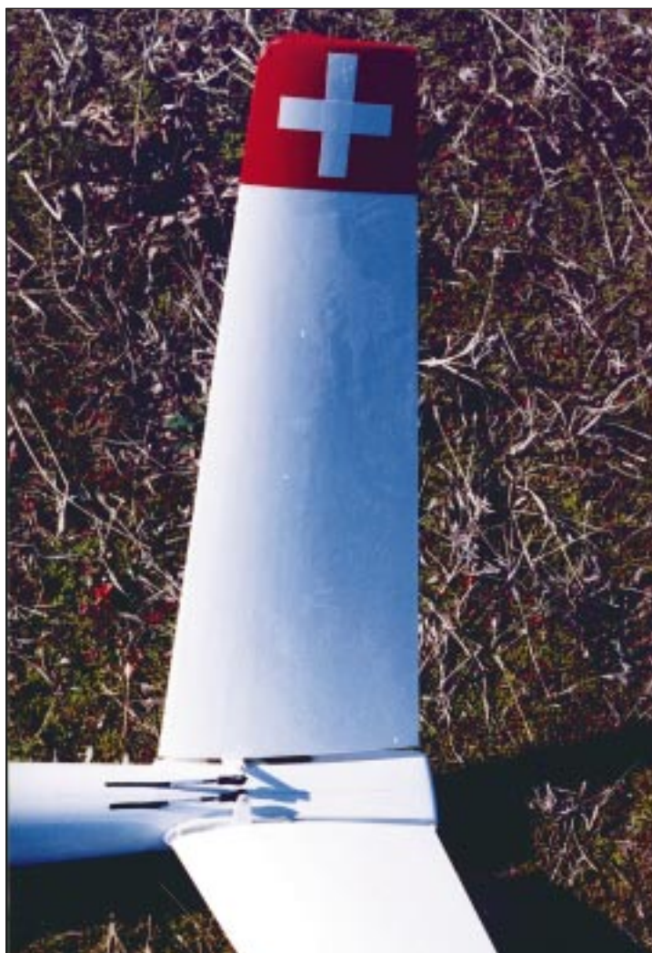
Il semplice e funzionale sistema del comando dei piani di coda a V.
