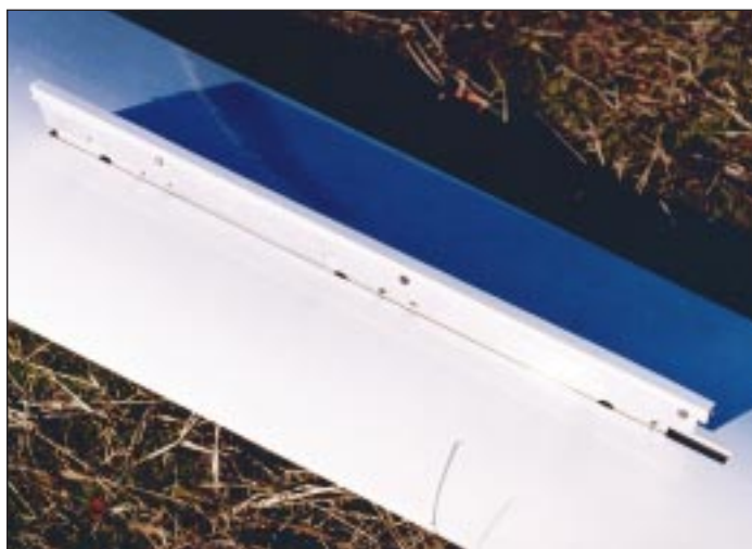
I freni aerodinamici sono particolarmente un must su un aliante di questa taglia, utilissimi per calibrare alla perfezione l'avvicinamento all'atterraggio.
