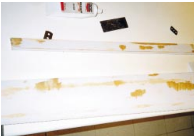
Un dettaglio dell'ala e dell'alettone accuratamente stuccati e la fase finale di lucidatura con platorello elettrico di lana d'agnello.
